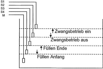
NIVA5 verwendet 5 Füllstandssonden. Die Sonden müssen im Pufferbecken so angeordnet werden, dass sich die Ebene für den Zwangsbetrieb (S1) unter dem Überlauf des Pufferbeckens befindet.
