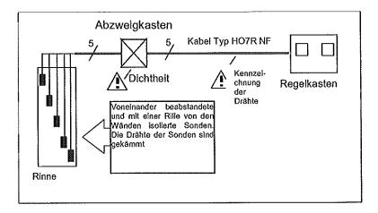
Um Verkabelungsfehler zu vermeiden, muss man unbedingt die mehrdrähtigen Kabel markieren, insbesondere wenn die Drähte keine verschiedenen Farben haben. Für den RO2V sorgt man zum Beispiel dafür, die Position der 2 schwarzen Drähte zu markieren.
