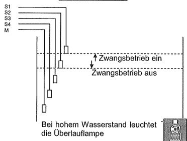
Der Überlauf wird erfasst, wenn der Wasserstand über der Sonde S1 liegt. Dann wird die Filterpumpe im Zwangsbetrieb eingeschaltet, bis der Stand wieder unter die Sonde S2 fällt.
